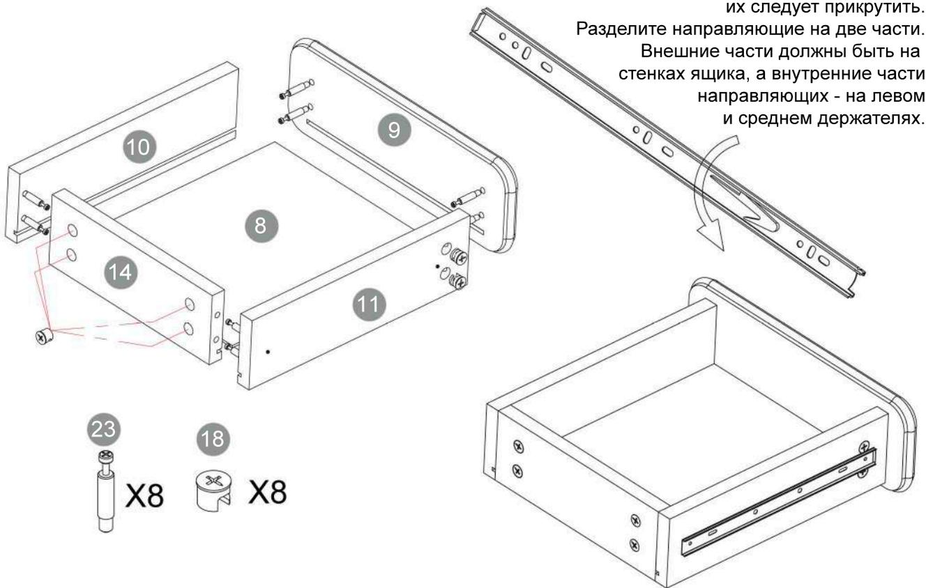
6. Вставьте 2 пластиковых и 1 деревянный ящик в ответные части направляющих на держателях.
