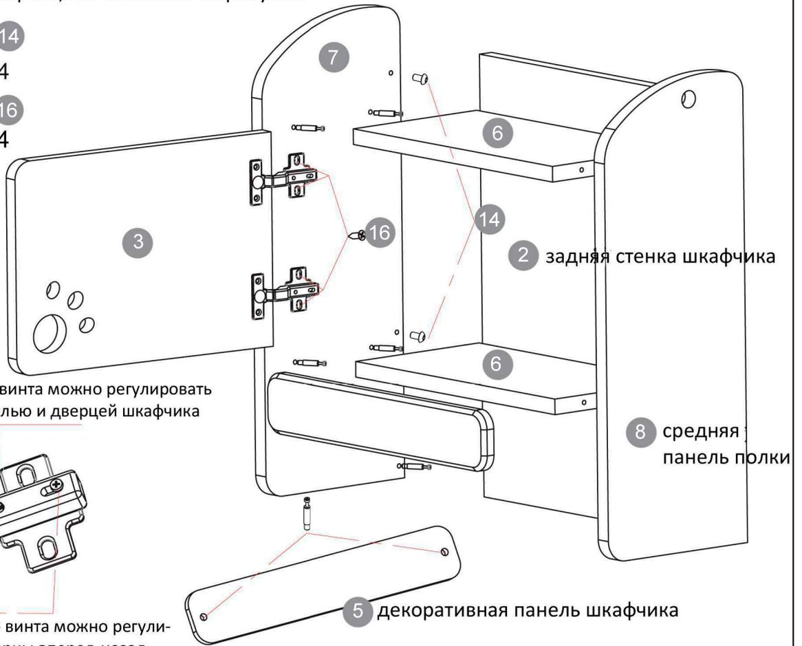
С помощью этого винта можно регулировать зазор между панелью и дверцей шкафчика
